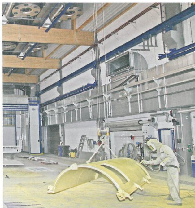
In Großraumlackieranlagen wie dieser können Anlagenbetreiber jetzt durch den Einsatz einer sektionalen Lüftung deutliche Energieeinsparungen von 50 bis 70% erzielen.
