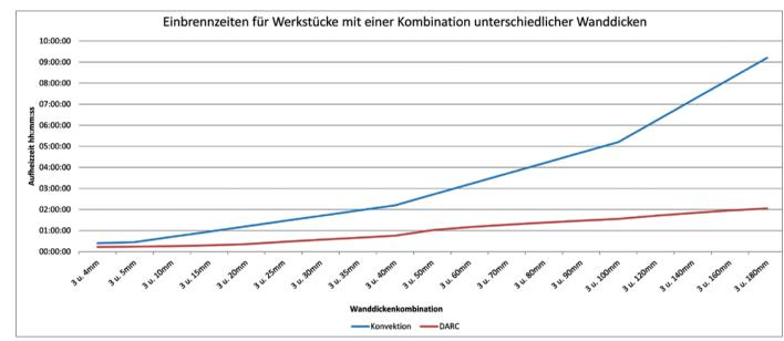
Mit Hilfe der "DARC"-Technologie lassen sich die Einbrennzeiten für Werkstücke mit einer Kombination unterschiedlicher Wandstärken erheblich reduzieren. Die dargestellten Einbrennzeiten für Konvektion entsprechen der in **▶ besser lackieren!** Nr. 14/2012, S. 4 gemachten Angaben. Die Werte für "DARC" stammen aus eigenen Versuchsreihen von SLF.
