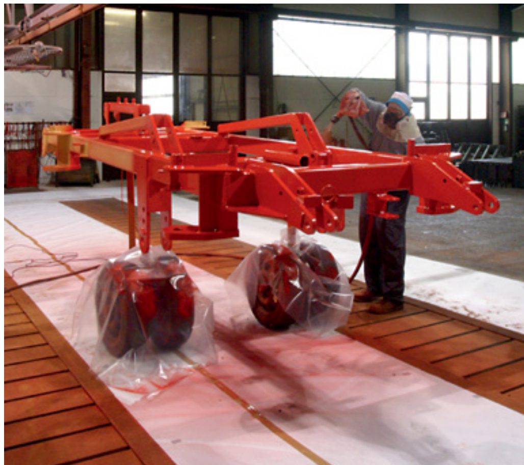
Die Luft wird mit einer Sinkgeschwindigkeit von 0,3 m/sek aus den Weitwurfdüsen gedrückt und von unten angesaugt. Damit ist es möglich, in der Halle ohne Einhausung oder Kabine zu lackieren.
