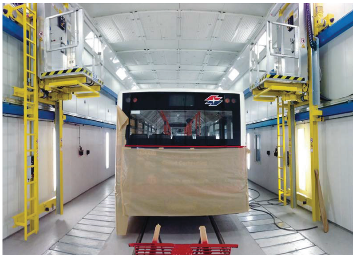
Busse können entweder vom Boden aus oder über die wandgeführten Hubarbeitsbühnen von den Lackierern bearbeitet werden, auf denen eine direkte Farbversorgung möglich ist. Quelle (zwei Fotos): SLF
