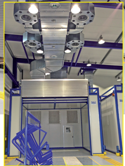
Großes Bild: Die Gesamtansicht der teleskopierbaren Wasch- und Trockenkabine verdeutlicht die Platzeinsparung in der Fertigungshalle bei Marti Technik. Kleines Bild: Im Hintergrund der Freilackierfläche mit Weitwurfdüsen ist der teleskopierbare Trockner in seiner Parkstellung zu sehen.
