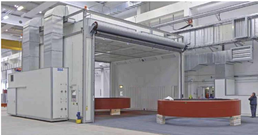
Die Spritz- und Trockenkabine fährt von einem Werkstück zum nächsten. Im Hintergrund: Zu- und Abluftkanäle mit Andockstationen. Bild: SLF
